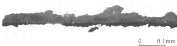
图五// No. 2号样品漆膜的断面
