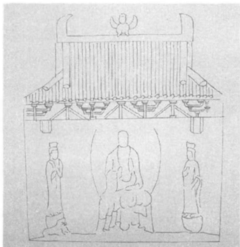
图7 古阳洞南壁中层仿木构石雕歇山顶屋形龕
