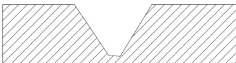
图五 磨刻法剖面图
