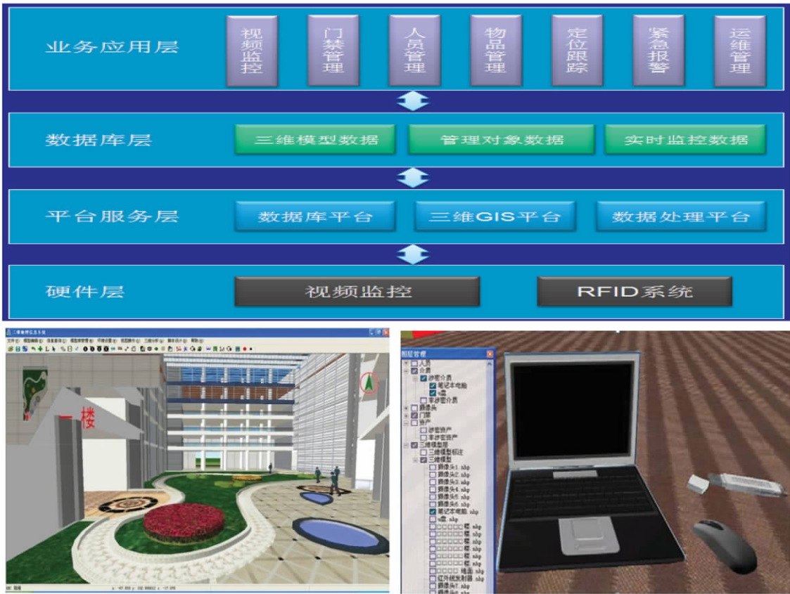
图 2 三维可视化智能安防系统总体结构图及运行界面
