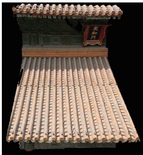
〔图十五:4〕结合纹理图像生成的彩色三角网模型
