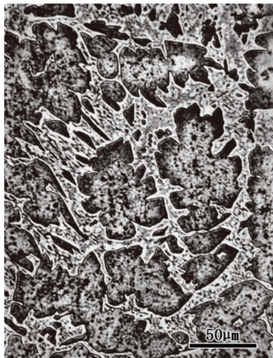
图 8 青铜矛 86006 骹部 \alpha 相和 \alpha + \delta 相组织
