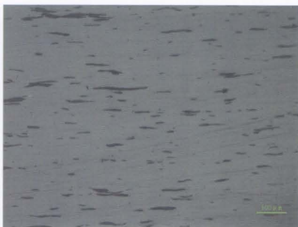
图版 6b 铁楔金相组织图 (100X) 纵向 浸蚀剂: 3% 硝酸酒精
