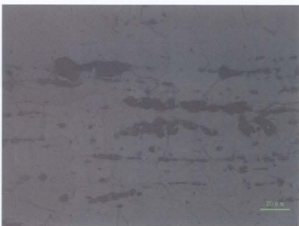
图版 7a 铁丝金相组织图 (500X) 纵向 浸蚀剂: 3% 硝酸酒精
