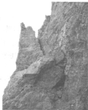
图3 开挖引起的土体整体滑落
