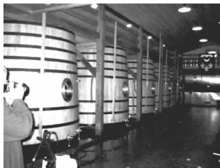
笔者 2002 年 12 月 4 日摄于法国波尔多的一个酒庄,注意这种发酵和储存两用的立式橡木桶
