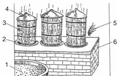
图4 传统甑桶结构及蒸饭图
